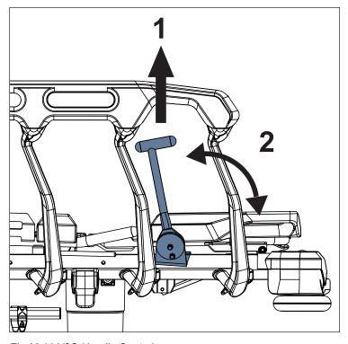
Fig. Mobi-Lift® Handle Control
